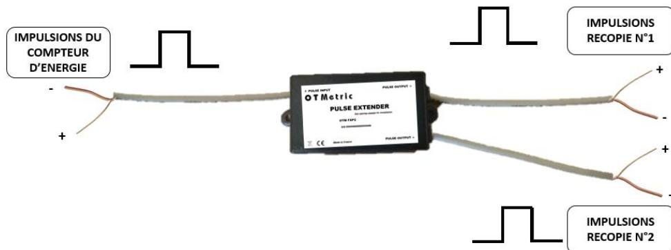
Le **TWIN PULSE** permet la duplication et le conditionnement de la sortie impulsionale d'un compteur vers 2 équipements distincts (automates, supervision, pompe doseuse, enregistreurs ...). Les impulsions générées en sortie sont calibrées afin de délivrer des signaux propres et réguliers quel que soit la forme des impulsions en entrée. Voir les caractéristiques techniques.
